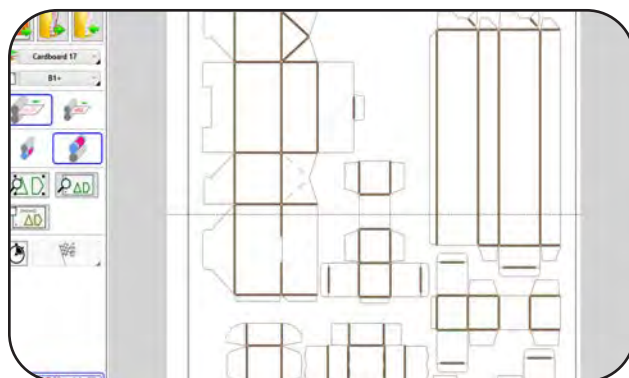
Préparation de la plaque de rainage Creasing Plate Preparation
